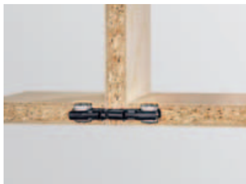
Łączniki środkowe – do połączenia DOMINO/DOMINO. Połączenie środkowe powstaje w taki sam sposób, jak połączenie kątowe. Jedyną różnicą: w środkowej ścianie trzeba wykonać otwór na wylot, przez który przekłada się łącznik.
