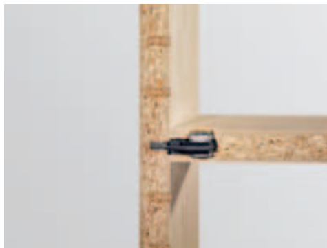
Łączniki kątowe – do połączenia DOMINO/LR 32. Łącznik kątowy DOMINO łączy otwór wykonany w systemie LR32 z podstawą konstrukcji. Okucie wkręca się bezpośrednio w 5-milimetrowy otwór w rzędzie, a podstawa konstrukcji montowana jest jak do tej pory, przy wykorzystaniu wyfrezowanego otworu DOMINO.
