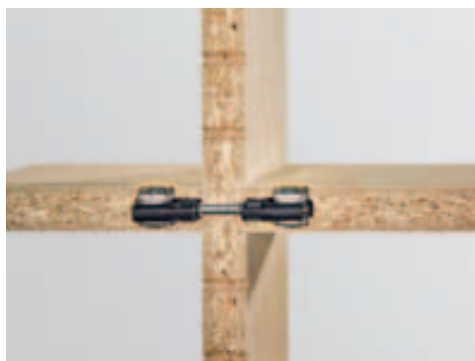
Łączniki środkowe – do połączeń DOMINO/LR 32. Łącznik środkowy DOMINO łączy na tej samej wysokości dwie podstawy konstrukcji z wykorzystaniem wykonanych w systemie LR32 otworów. Okucie wkręca się bezpośrednio w 5-milimetrowy otwór w rzędzie i zakotwicza wyfrezowanym w podstawie konstrukcji otworze DOMINO.
