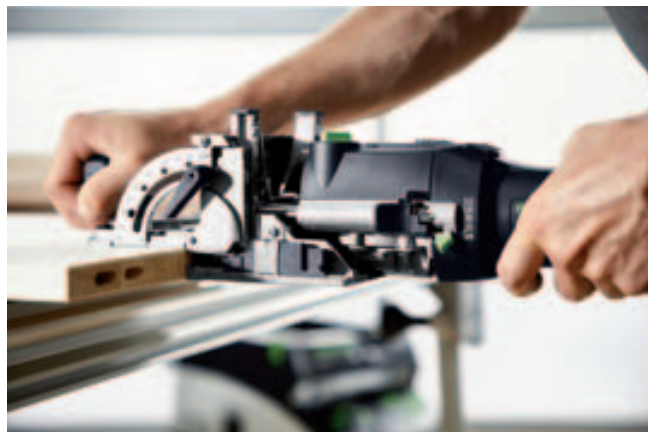
Nowe łączniki mocowane za pomocą frezarki do połączeń DOMINO DF 500, która wykonuje otwór frezem o średnicy 8 mm.
